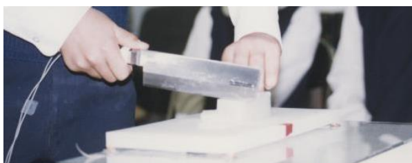
写真1 包丁の把持力とまな板への荷重 の測定風景
