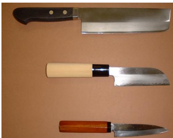
図1 実験に用いた包丁 上段：菜きり包丁 中段：むきもの包丁 下段：果物包丁
